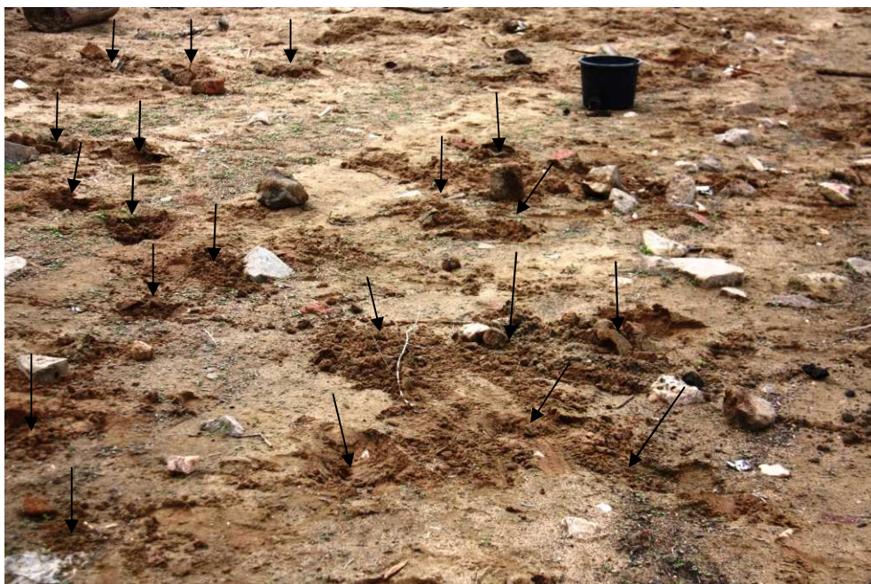
Obr.12 Pláž pod bazénem po průchodu pyrotechnika. Každé kopnutí (šipka) Představuje jeden železný předmět (munici, obvykle RG nebo odpadky).
