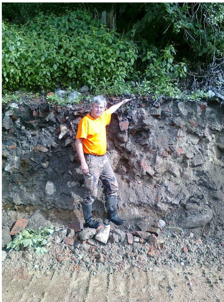
Obr.13 Mocnost vrstvy stavebná suti na břehu je z obrázku zřejmá (výška pyrotechnika 185 cm)
